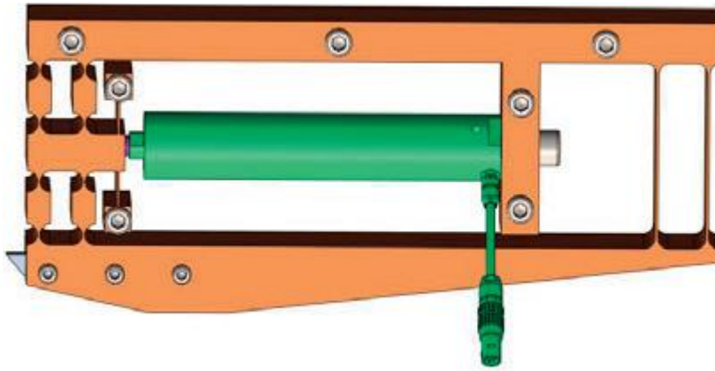
Hình 1. 29: Mô hình cơ cấu ăn dao [59]
