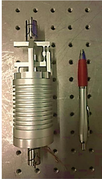
Hình 1. 15: Hệ thống một bậc tự do ngăn rung động
