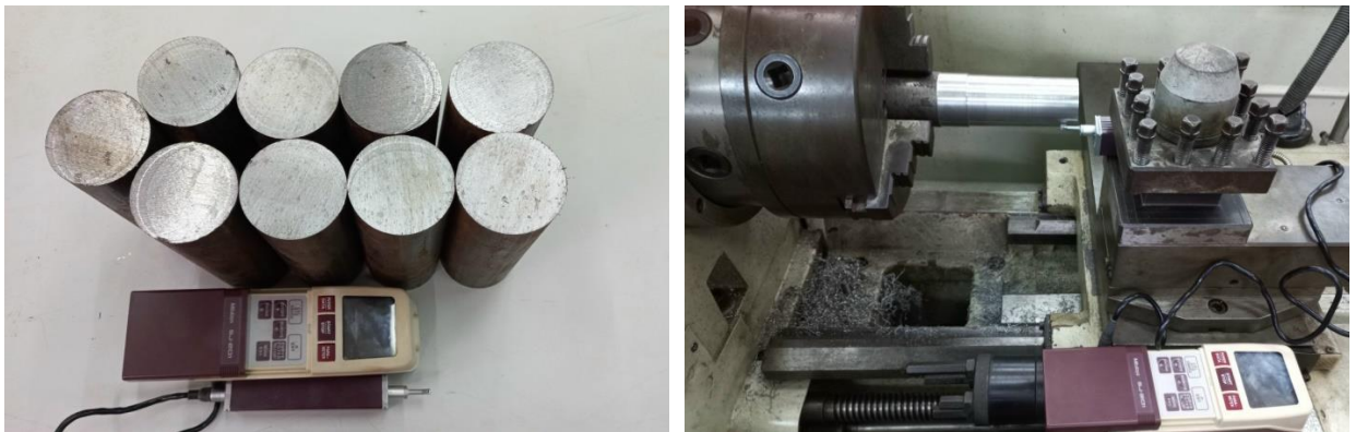
Hình 4. 27: Thực nghiệm đo độ nhám khi gia công
